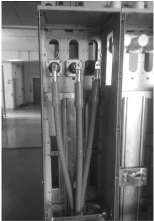
图12 电缆屈曲试验平台
